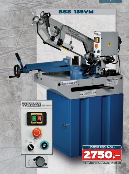
Motor 230 V Hydraulische oder manuelle Absenkung Inklusive Sockel und Kühlmittelpumpe
