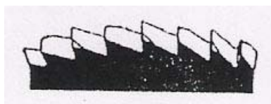
"Denture "AW Denture fine avec angle de coupe alterné
