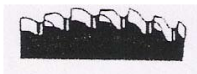
Denture C(HZ) : Denture de grande surface avec denture d'ébauche avec râteau des deux côtés, alternée avec une denture de finition sans râteau. La dent d'ébauche est plus haute de 0,15-0,30 mm.
