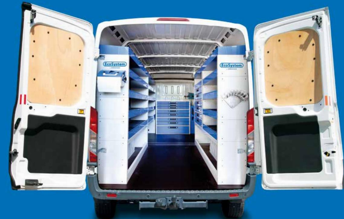
geringes Eigengewicht · thermolackierte Stahlgehäuse · Werkbank integrierbar
